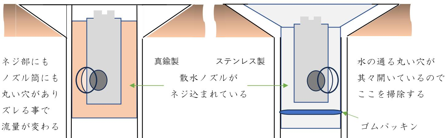
ドライバーで左右90°以内で回し水量調整する(穴同志がズレる事で流量が変わる為回し過ぎると塞がる)
